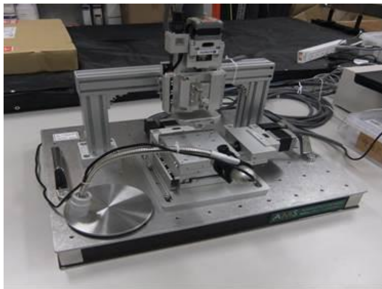
図1 ニードル式ディスペンサ（分子センサ塗布装置）
